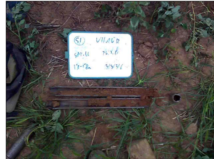
Foto 31: Material extret de l'assaig SPT-1.1.
