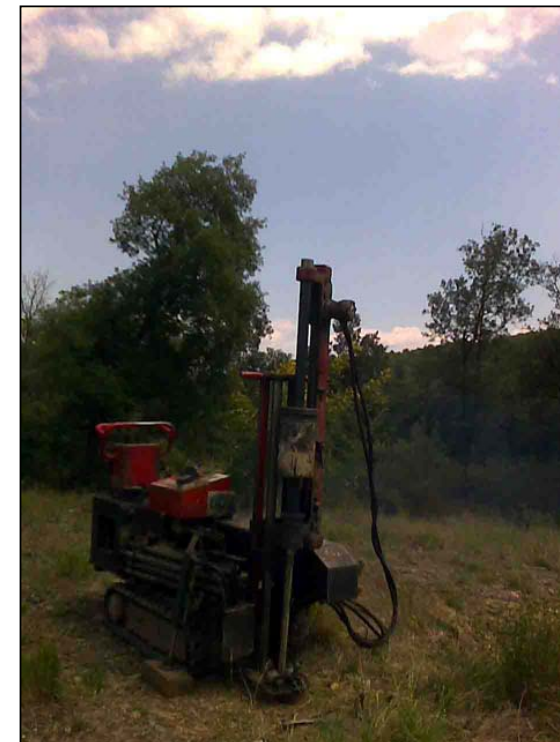
Foto 16: Assaig de penetració dinàmica PD-4.
