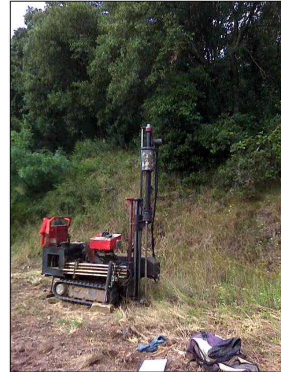
Foto 15: Assaig de penetració dinàmica PD-3.
