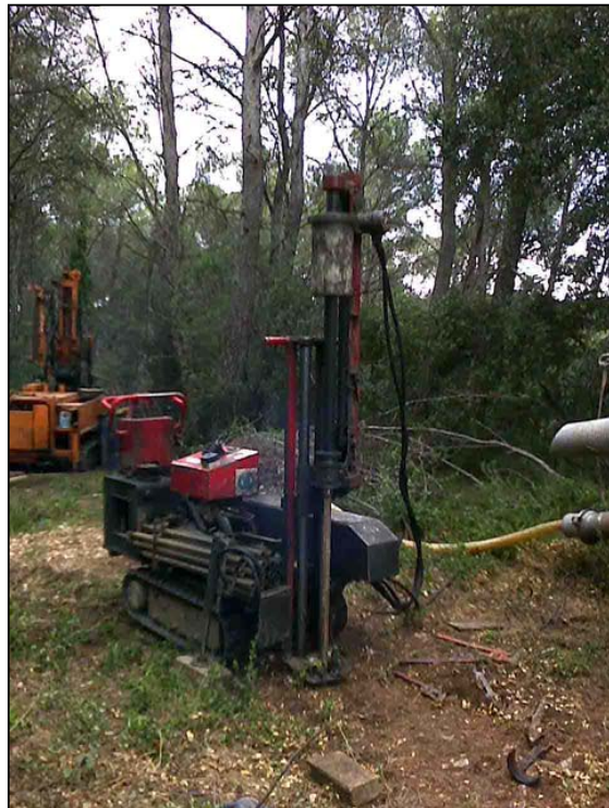
Foto 14: Assaig de penetració dinàmica PD-2.
