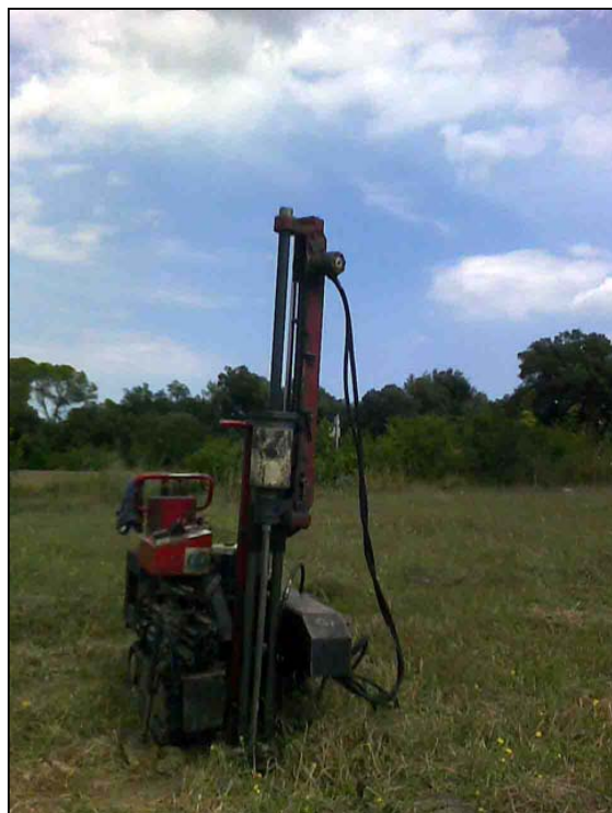
Foto 18: Assaig de penetració dinàmica PD-6.
