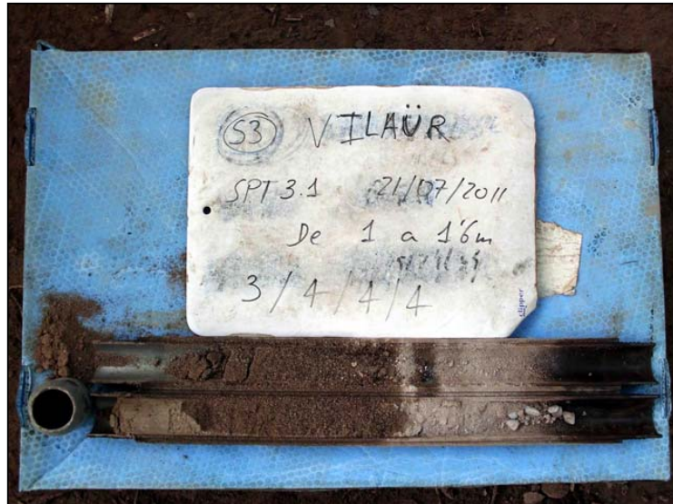
Foto 33: Material extret de l'assaig SPT-3.1.
