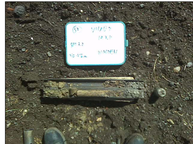
Foto 36: Material extret de l'assaig SPT-7.2.
