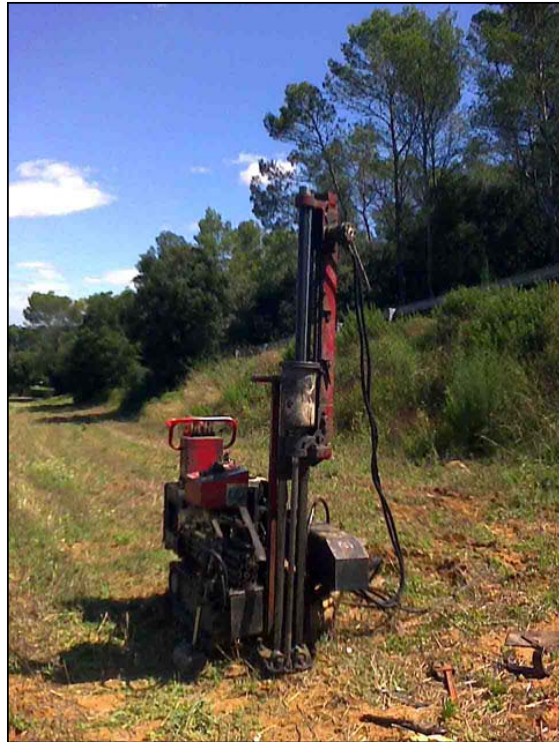
Foto 13: Assaig de penetració dinàmica PD-1.
