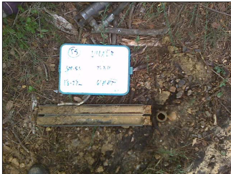
Foto 34: Material extret de l'assaig SPT-5.1.
