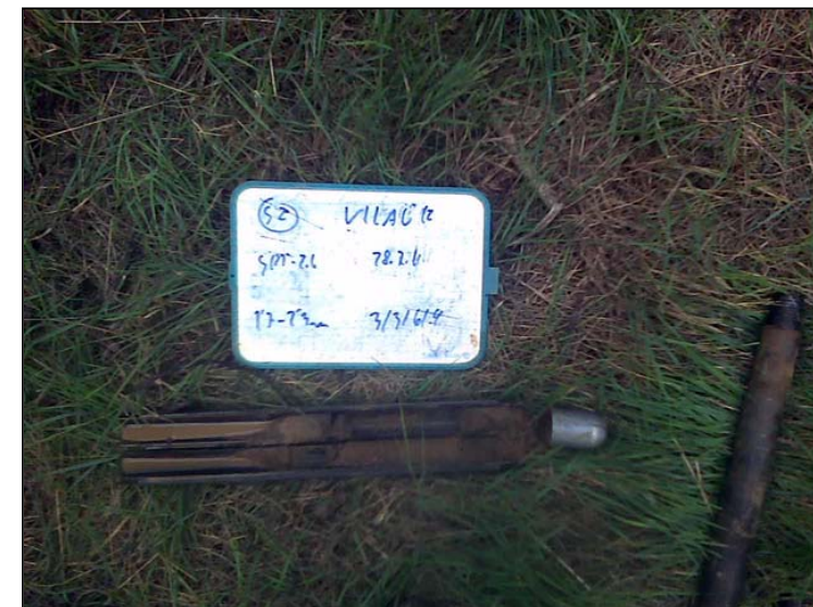
Foto 32: Material extret de l'assaig SPT-2.1.
