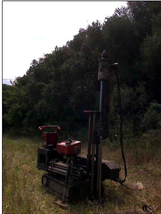
Foto 17: Assaig de penetració dinàmica PD-5.
