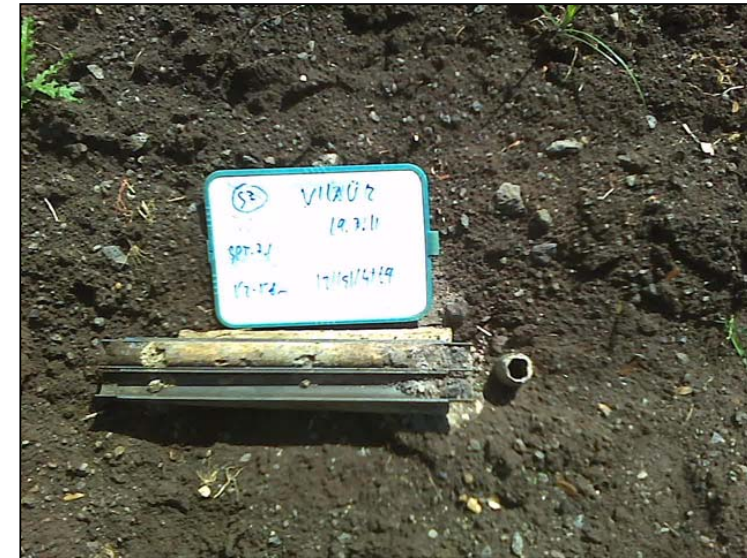
Foto 35: Material extret de l'assaig SPT-7.1.
