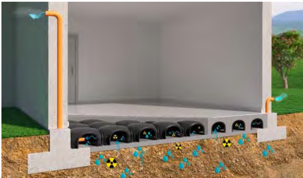
Figura 5.5. Esquema constructiu del sistema Iglu'.
