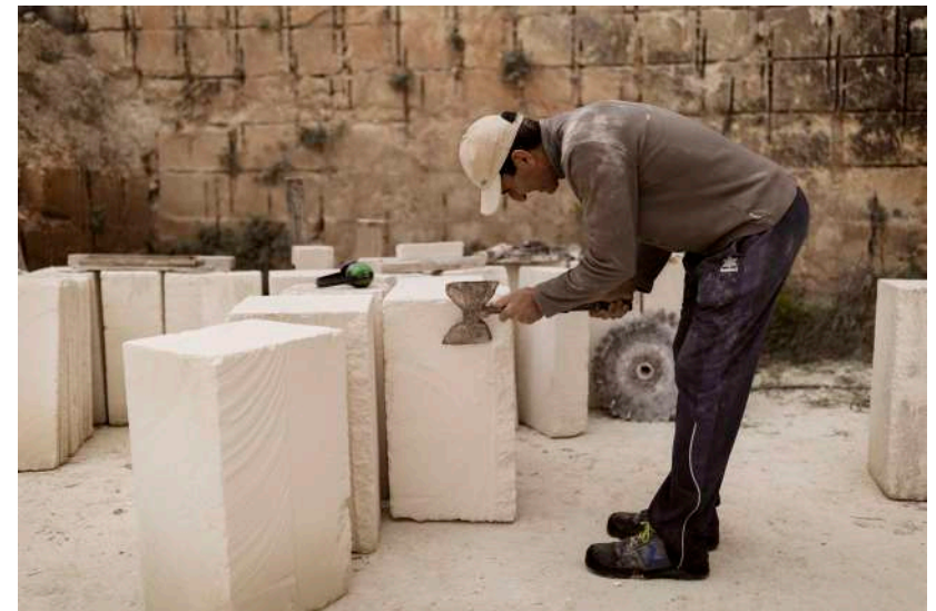
25 - Bloc de marès, pedra arenosa de les illes Balears que s'utilitza en la construcció de murs i voltes. L'ús d'aquest material afavoreix el respecte pel medi ambient i la conservació de la cultura i les tradicions de l'illa.
