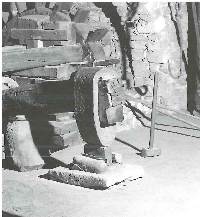
El mall d'un martinet de farga de ferro, en la reconstrucció del Museu de Ripoll.
