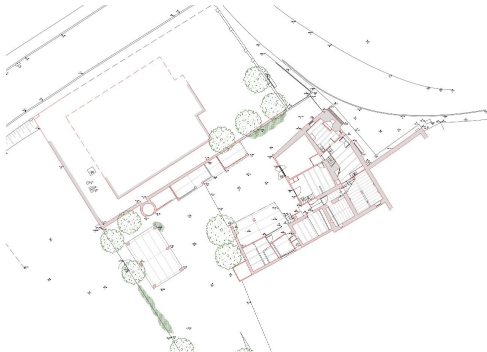
Topogràfic de la parcel·la abans de l'enderroc de les construccions auxiliars
