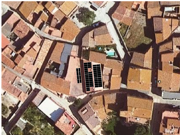
Figura 2.- Distribució de panells sobre les cobertes
