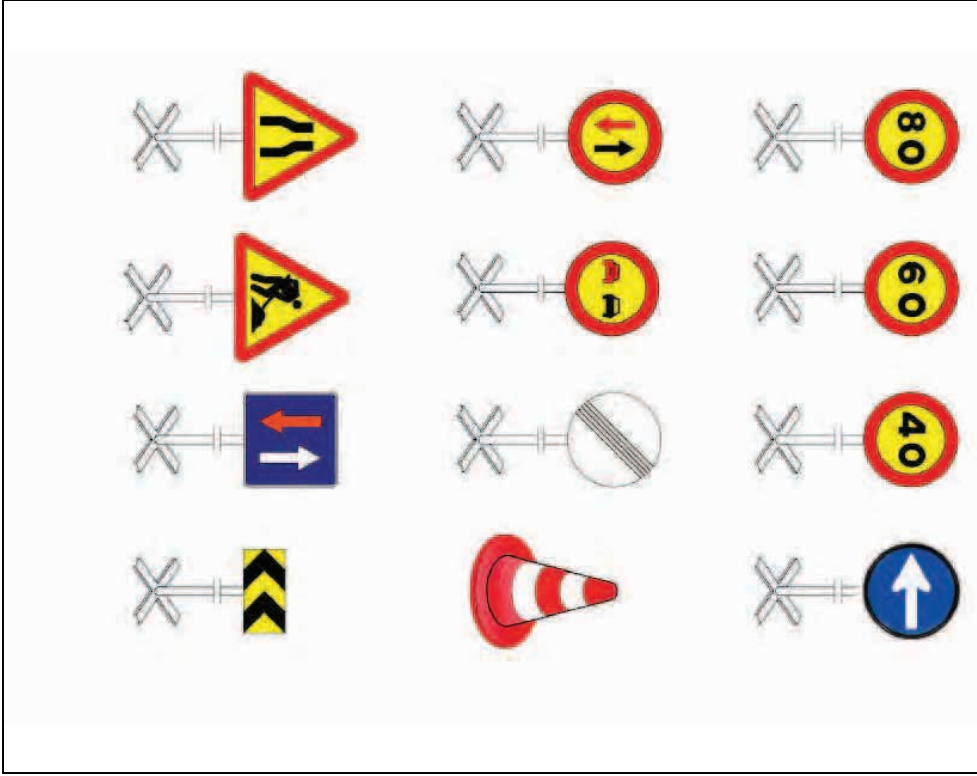
Equip estàndard Senyalització provisional d'obres per carretera convencional Equip de senyalització provisional
