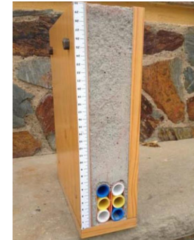
Exemple de secció de microrasa de 6c20 amb reblert de morter
