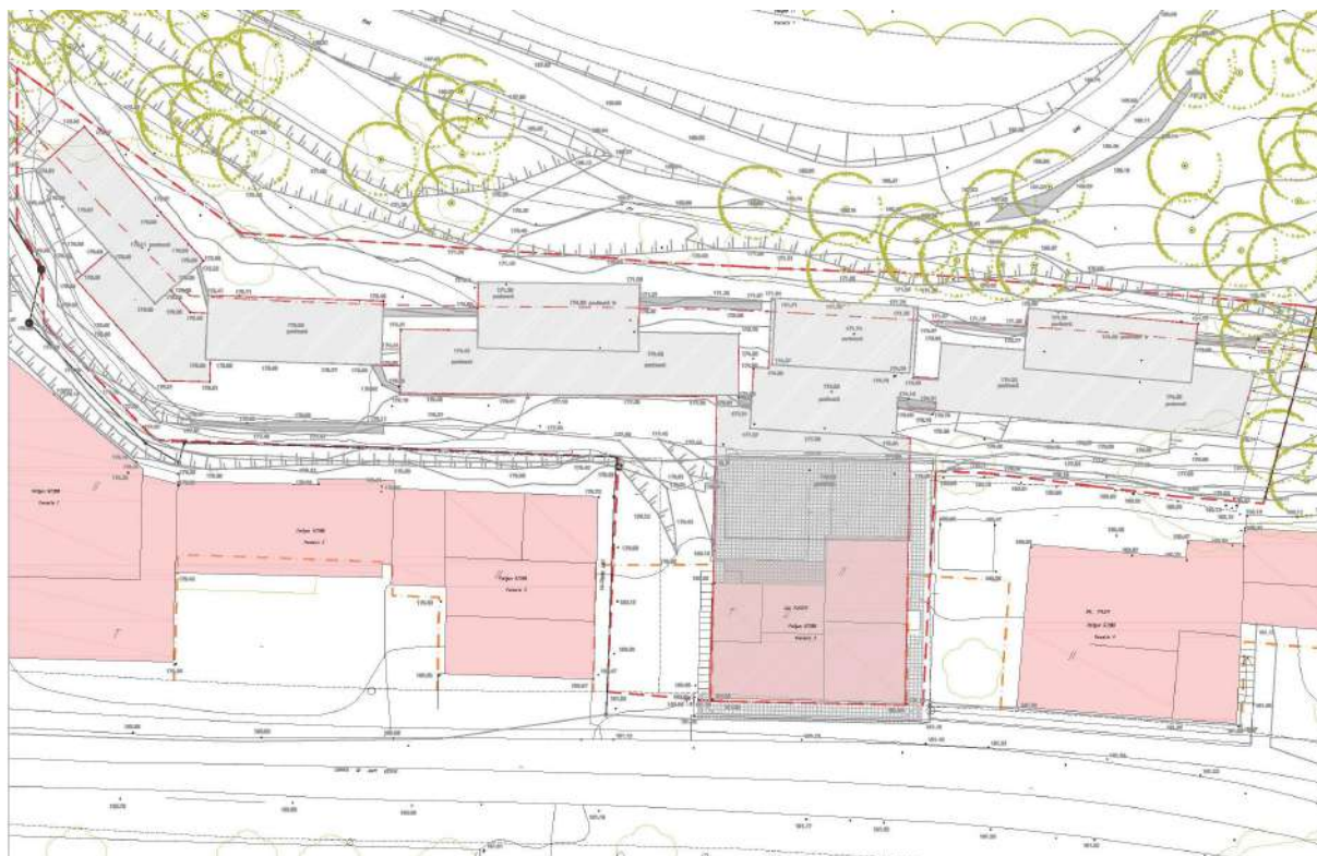
Fig 7. Unitats d'allotjament temporal segons obra executada de la llicència d'obra presentada a 2003. Les edificacions es troben parcialment construïdes ( ocupació sobre el terreny de fonamentació, estructura, cobertes i tancaments a 2018)
