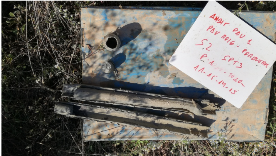
Foto 18: Detall del SPT 2 del sondeig SR-2 de 10.0 a 10.6 m de profunditat.
