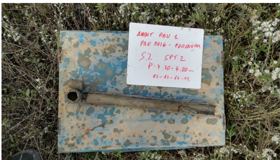
Foto 16: Detall del SPT 1 del sondeig SR-2 de 4.2 a 4.8 m de profunditat.
