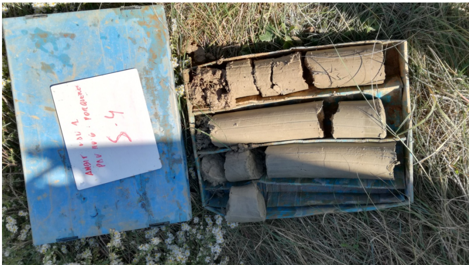
Foto 22: Caixa del sondeig SR-4 de 0 a 2.0 m de profunditat.
