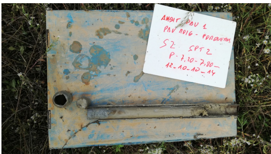
Foto 17: Detall del SPT 2 del sondeig SR-2 de 7.2 a 7.8 m de profunditat.
