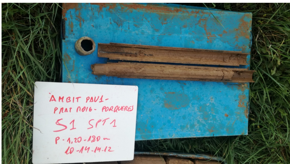
Foto 8: Detall del SPT 1 del sondeig SR-1 de 1.2 a 1.8 m de profunditat.
