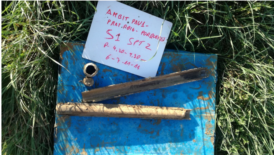
Foto 9: Detall del SPT 2 del sondeig SR-1 de 4.2 a 4.8 m de profunditat.
