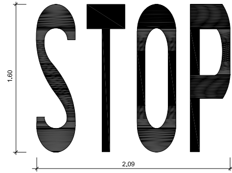
DETALL 010500 Senyalització horitzontal Stop S= 1.29 m 2 ESCALA 1:20
