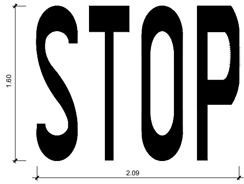
DETALL 010500 Senyalització horitzontal Stop S= 1.29 m 2 ESCALA 1:20
