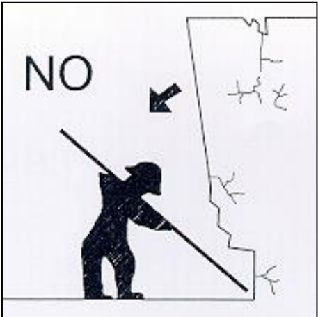
EXCAVACIÓ SOTA TALÚS
