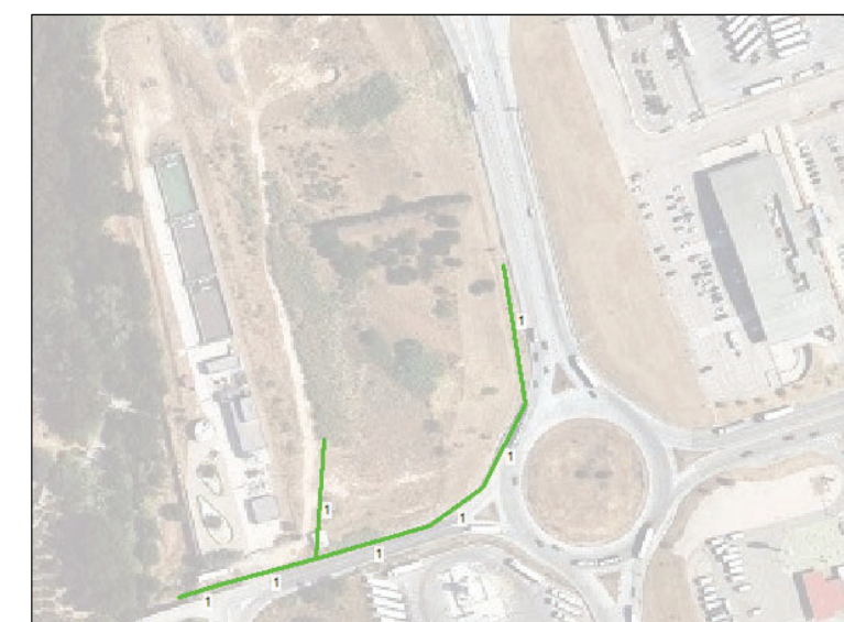
Figura 12. Vista en planta de les conduccions considerades en el model de l'estat actual. El nombre que acompanya els conductes indica l'alçada màxima en metres.
