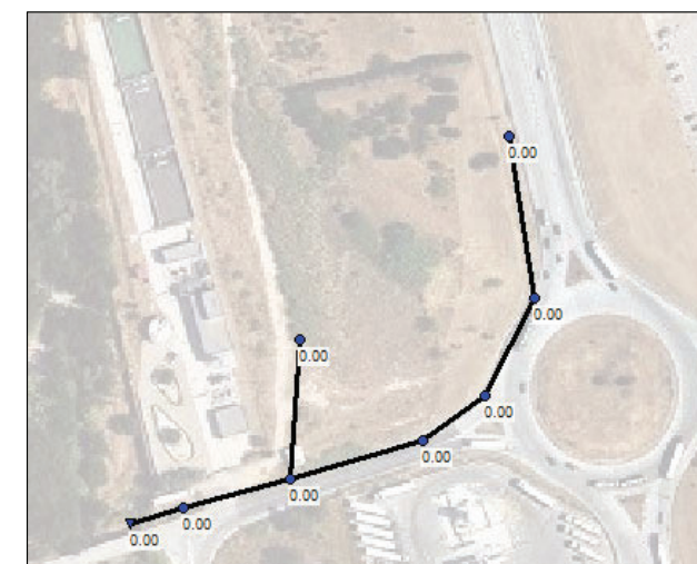
Figura 16. Desbordament de nusos d'enllaç en l'instant més crític de l'episodi de precipitació simulat. S'observa que no desborda cap punt.
