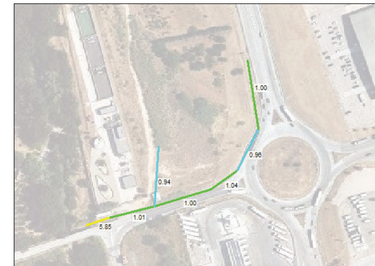
Figura 11. Traçat de les conduccions considerades en la modelització de l'estat actual del sector. El nombre que acompanya els conductes indica la pendent de fons en tant per cent (%).
