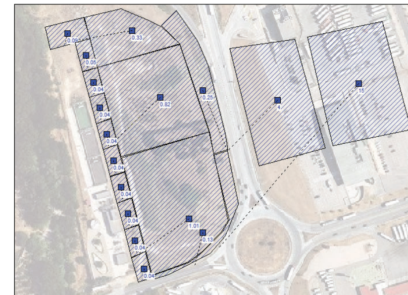
Figura 19. Vista en planta de les conques tributàries del sector desenvolupat. El nombre que acompanya els elements indica l'àrea en Ha.
