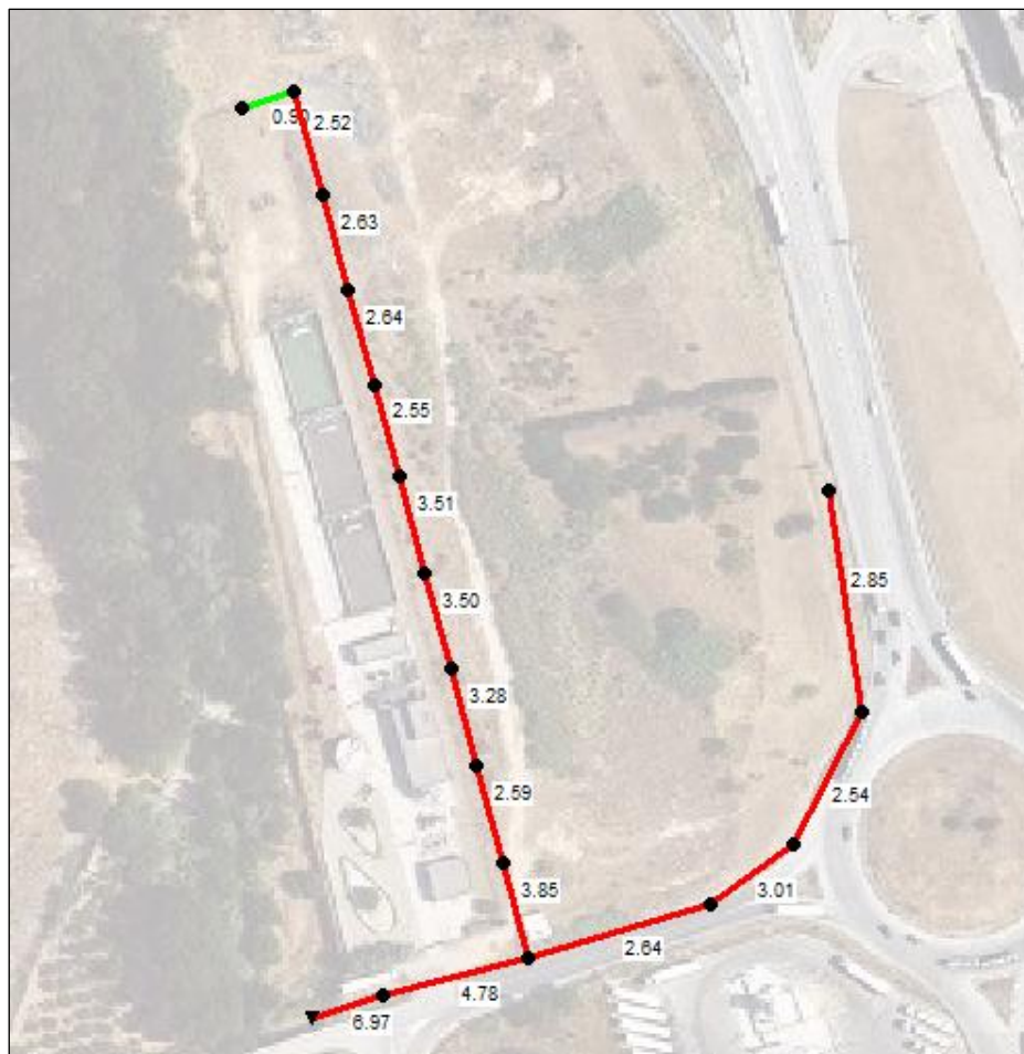
Figura 24. Vista en planta de l'eix de drenatge. El nombre que acompanya les conduccions indica la velocitat assolida per l'aigua en l'instant més crític de l'episodi modelitzat.
