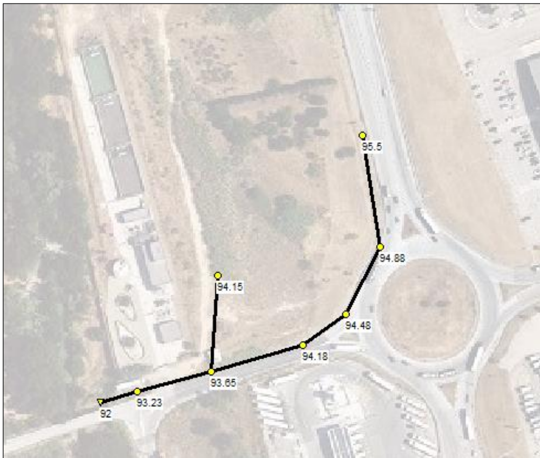
Figura 14. Cotes de fons (en msnm) dels nusos d'enllaç considerats per modelitzar l'estat actual del sector.
