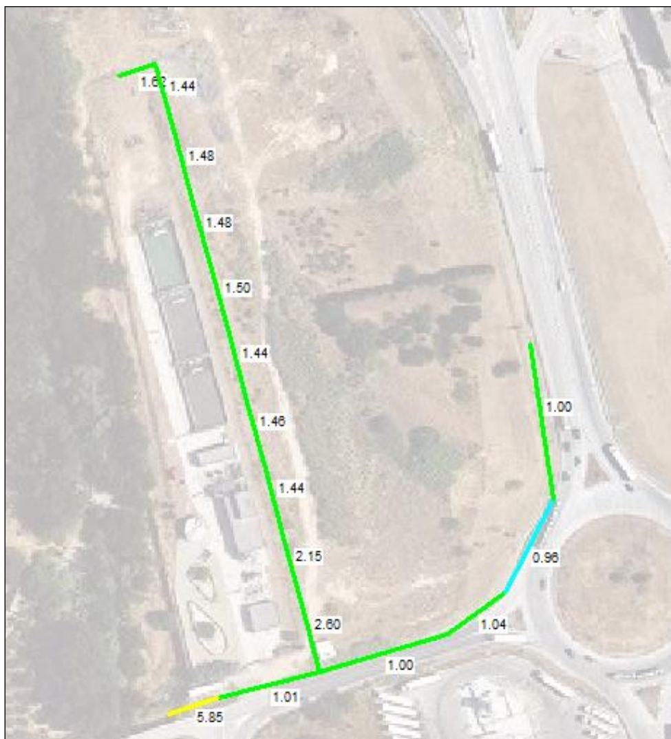
Figura 20. Vista en planta de les conduccions considerades per modelitzar el sistema de drenatge del sector desenvolupat. El nombre que acompanya els elements indica la pendent de fons dels tubs en tant per cent (%).
