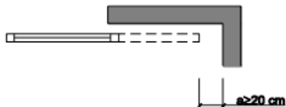
Figura 2.1 Holgura para evitar atrapamientos
