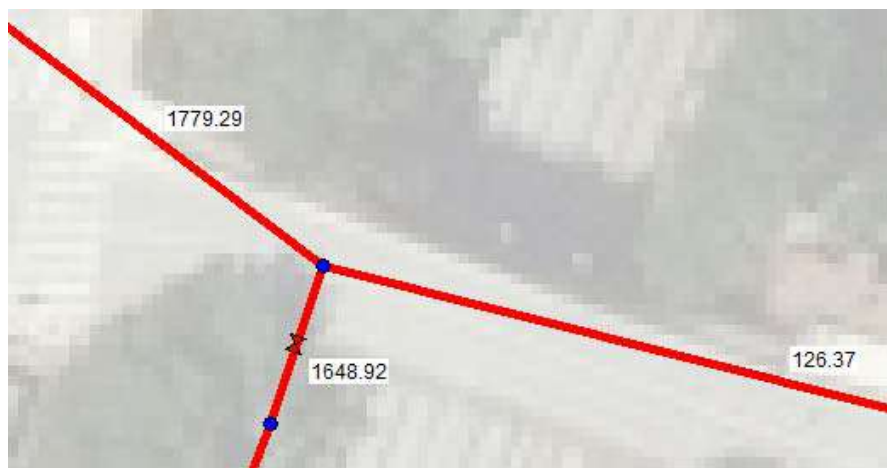
Figura 9. Vista en planta del sobreexidor 1 en l'instant més crític de l'episodi modelitzat. Es pot observar que el cabal sobreexidit és 16 vegades superior al cabal que es deriva cap a la xarxa de drenatge de l'altre costat de la via. (La xifra que acompanya els conductes indica el cabal en L/s).
