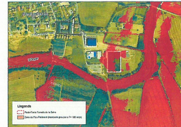
Figura 2: Zona d'inundació greu per a l'avinguda de 100 anys de període de retorn (Zona de Flux Preferent)
