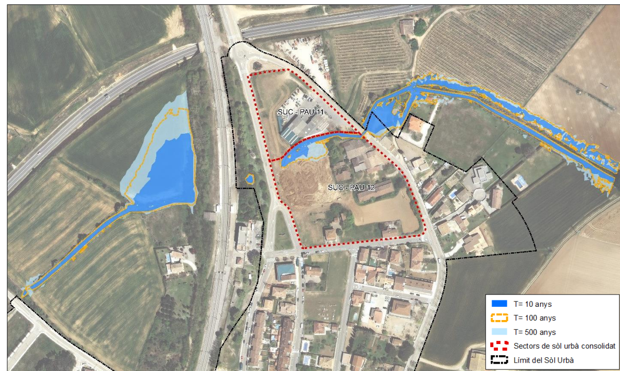
Delimitació de les zones inundables per a 10, 100 i 500 anys de període de retorn de la riera de Can Bosquets
