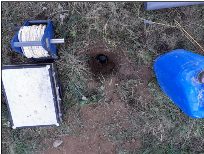
Foto 4. Assaig de Lefranc a l'interior del sondeig S-2 sobre el nivell N2 de roca saulonosa.
