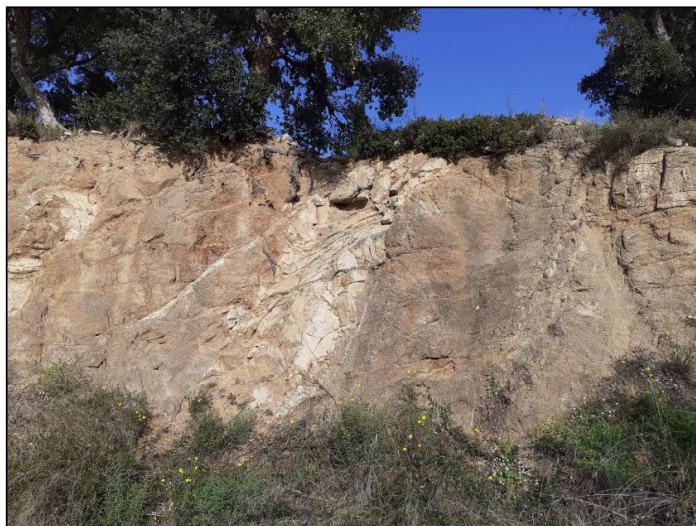
Foto 3. Detall del tall de 4m excavat per sota del cementiri. Entre la roca saulonosa d'uns 2-3m de potència s'observen filons de roques lecogranítiques subverticals, seguint la direcció i cabussament de la resta de la roca granítica.
