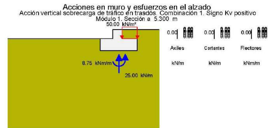
Carga de tráfico en coronación de muro
