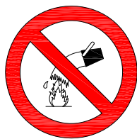
PROHIBIT APAGAR AMB AIGUA
