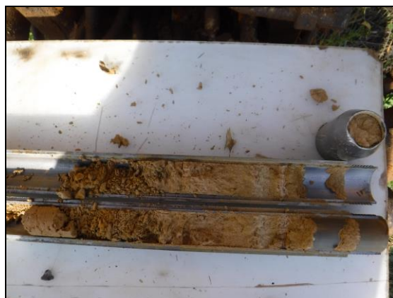
Foto 14: Sondeig S-4, SPT a 5,6 metres.
