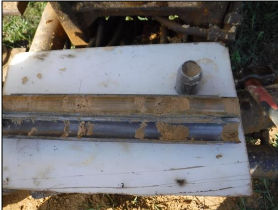
Foto 31: Sondeig S-9, SPT a 5,6 metres.
