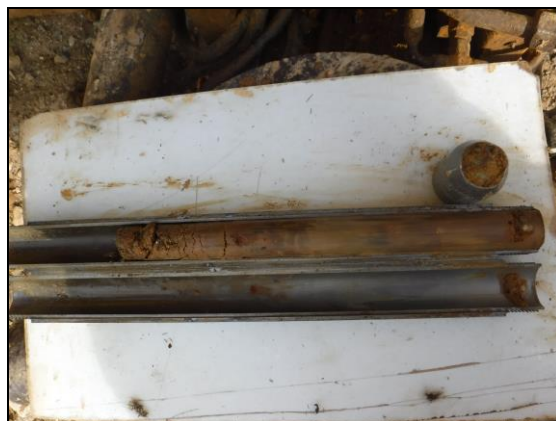
Foto 52: Sondeig S-15, SPT a 3,0 metres.
