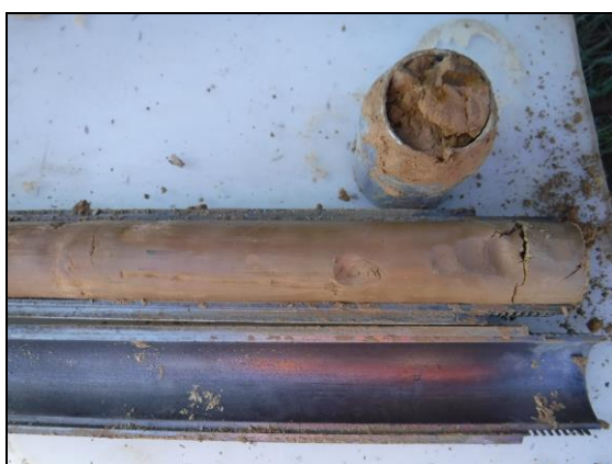
Foto 41: Sondeig S-12, SPT a 7,2 metres.
