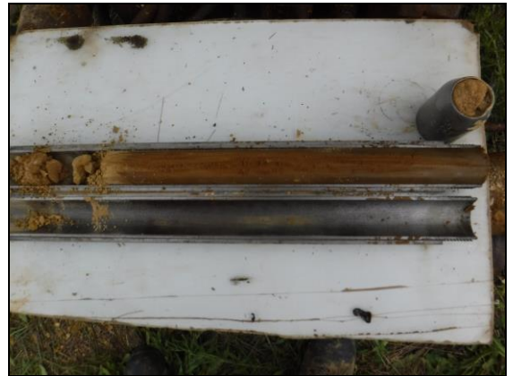
Foto 2: Sondeig S-1, SPT a 2,1 metres.
