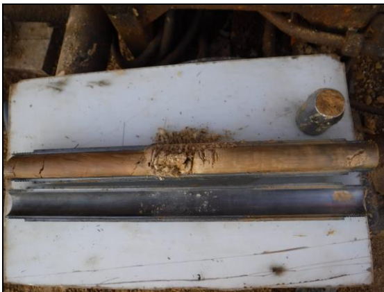
Foto 27: Sondeig S-8, SPT a 4,6 metres.
