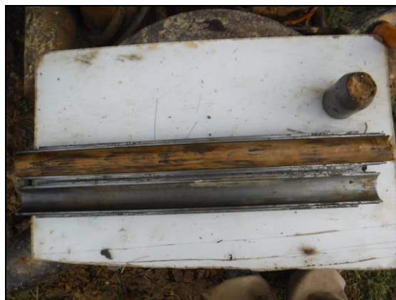
Foto 48: Sondeig S-14, SPT a 3,6 metres.
