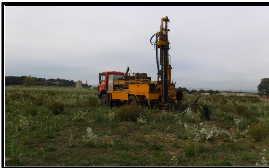
Aspecte del terreny estudiat i màquina situada a una de les perforacions.
