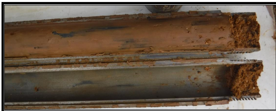
Materials de la capa A, recuperats a un assaig SPT.
