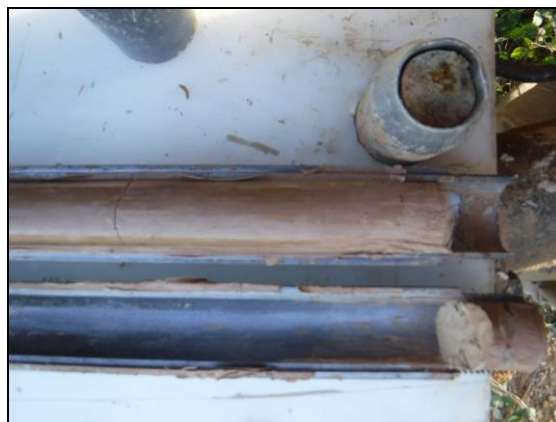
Foto 38: Sondeig S-11, SPT a 5,6 metres.
