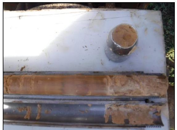
Foto 30: Sondeig S-9, SPT a 1,5 metres.
