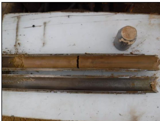
Foto 9: Sondeig S-3, SPT a 1,6 metres.
