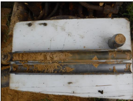
Foto 3: Sondeig S-1, SPT a 5,7 metres.
