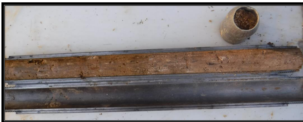
Materials de la capa R, recuperats a un assaig SPT.
