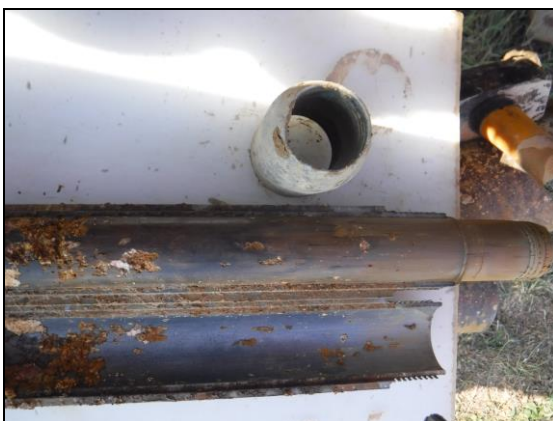
Foto 35: Sondeig S-10, SPT a 8,4 metres.
