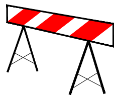
BARRERA METÀL·LICA DE DESVIACIÓ DEL TRÀNSIT
