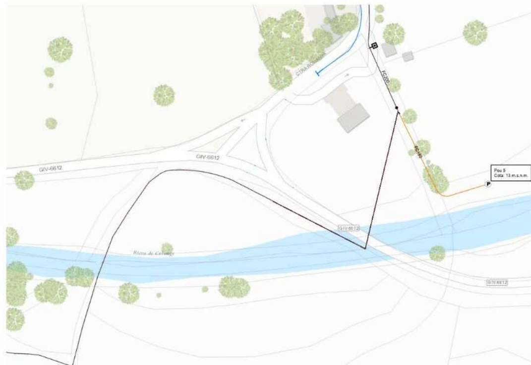
Figura 2 Canonades d'aigua potable de fibrociment 200 mm de diàmetre (negre) i escomeses (marró, blava i taronja)
