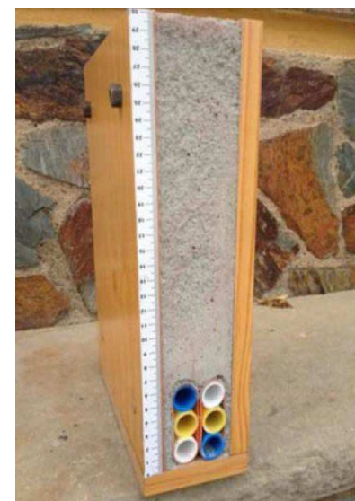
Figura 24. Exemple de secció microrasa de 6c20mm amb reblert de morter
