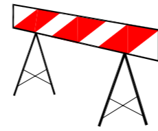
BARRERA METÀL·LICA DE DESVIACIÓ DEL TRÀNSIT
