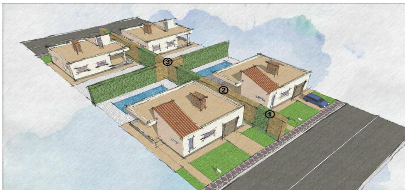
**Imagen 75.** Puntos prioritarios para la ubicación de discontinuidades incombustibles. 1. Máxima accesibilidad. 2. Cercanías de ventanas. 3. Cruceta de conexión entre diferentes parcelas. (Fuente: Medi XXI)
