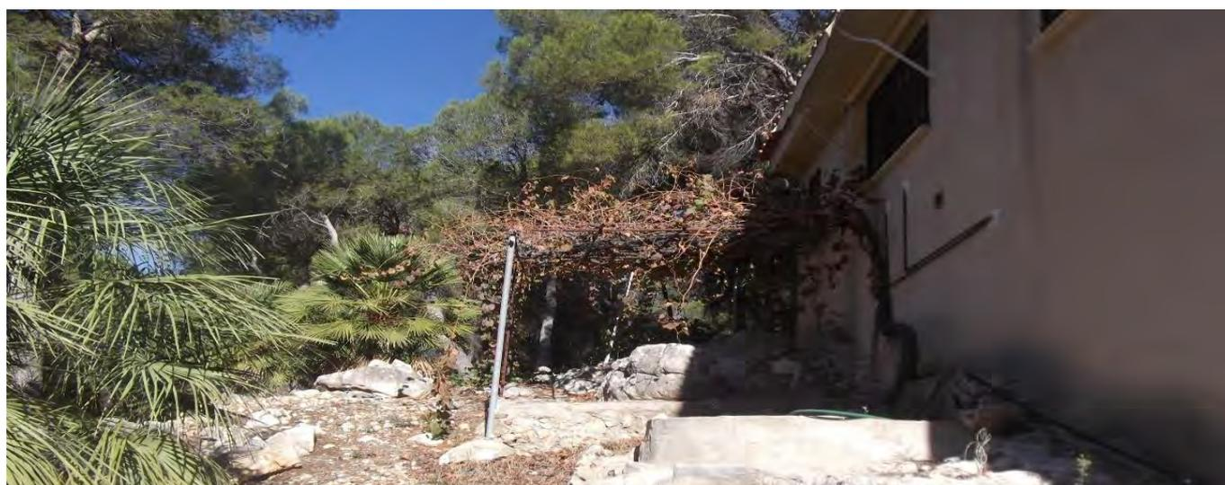
**Imagen 55.** *Cubierta de vid (Vitis vinifera) muerta y seca, altamente combustible y en las inmediaciones de la ventana, parte vulnerable de la vivienda. (Fuente: Medi XXI)*
