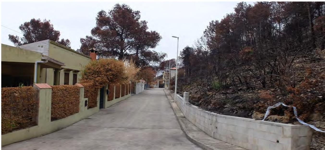
**Imagen 73.** *El entorno de nuestra propiedad es fundamental para elegir un vallado vegetal o totalmente artificial. Aunque existan discontinuidades, como las de esta vivienda, en las proximidades de una masa forestal, sin la existencia de una franja perimetral, la vegetación arderá y comprometerá la seguridad de los medios de extinción para trabajar, la nuestra propia y la de nuestros tuyos. (Fuente: Medi XXI)*
