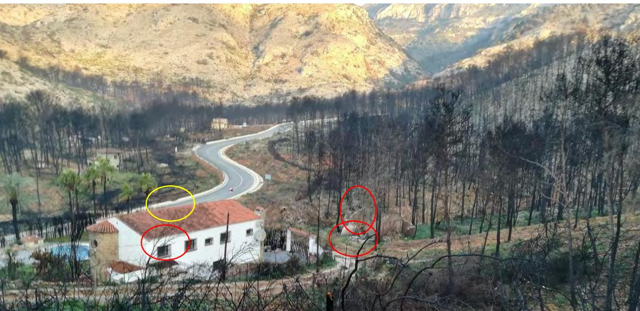
**Imagen 64.** *El material de construcción empleado en la vivienda ha resistido una alta intensidad de fuego y la afectación parcelaria se resume en la quema del vallado vegetal de ciprés, pese a las discontinuidades con la masa forestal existentes (vías de comunicación). Las palmas secas acumuladas por falta de poda en las palmeras se han quemado y ha permanecido la parte viva en el paisaje. (Fuente: Medi XXI)*
