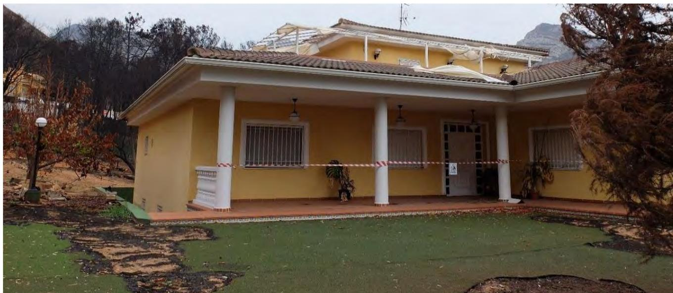
**Imagen 59.** Tapizado verde simulando césped. Este tipo de recubrimientos artificiales deben evitarse en ubicaciones de interfaz urbano-forestal por su inflamabilidad. (Fuente: Medi XXI)
