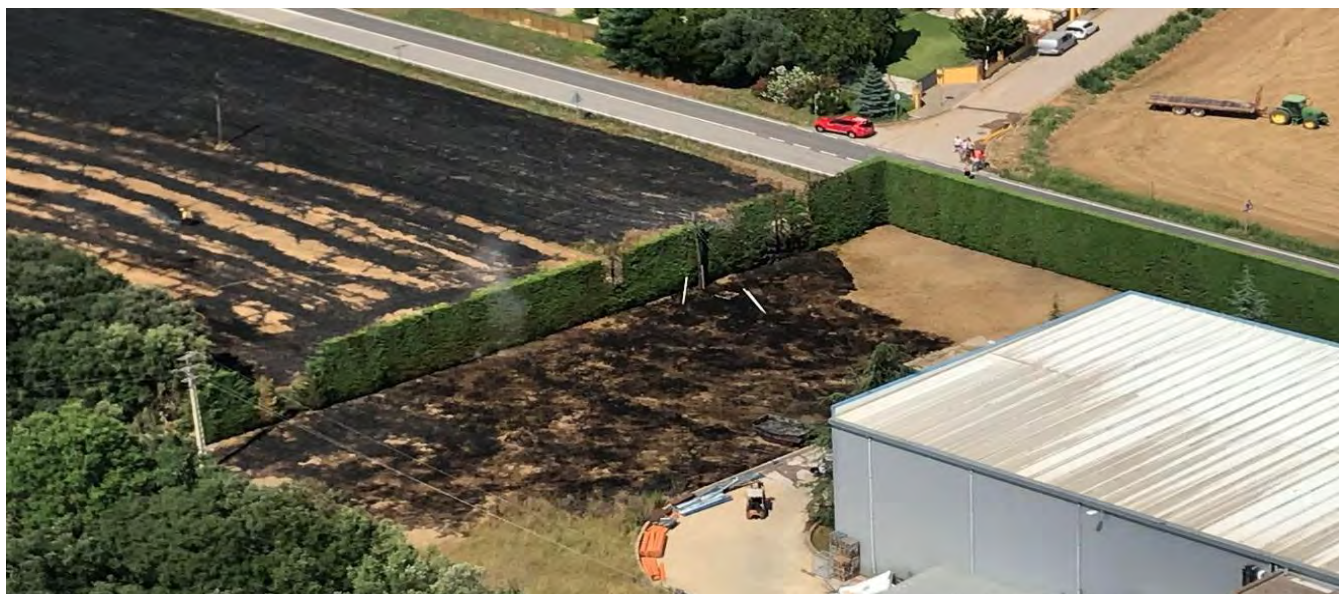
Imatge 63. Permeabilització d'una crema agrícola a una industrial per l'existència d'una tanca vegetal d'espècie inflamable. (Font: Lluís Regincós. Bombers de la Generalitat de Catalunya.)
