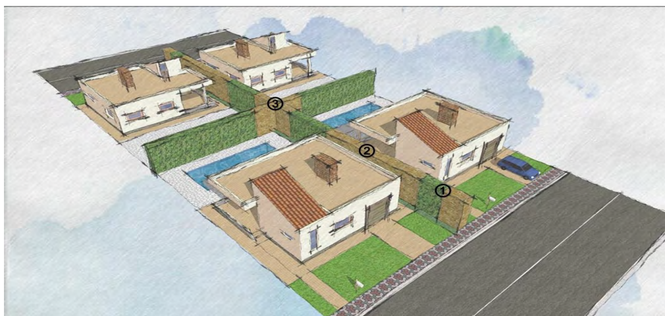
Imatge 75. Punts prioritaris per a la ubicació de discontinuïtats incombustibles. 1. Màxima accessibilitat. 2. Proximitat a finestres. 3. Creu de connexió entre diferents parcel·les. (Font: Medi XXI)
