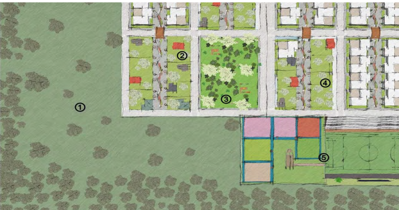
Imatge 15. Croquis preventiu del marge d'una urbanització en contacte amb la massa forestal en una interfície urbano-forestal. (Font: Medi XXI)
