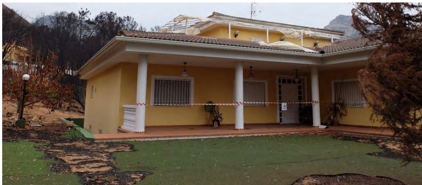
Imatge 59. Entapissat verd que simula gespa. Cal evitar aquest tipus de recobriments artificials en ubicacions d'interfície urbano-forestal per la seva inflamabilitat. (Font: Medi XXI)
