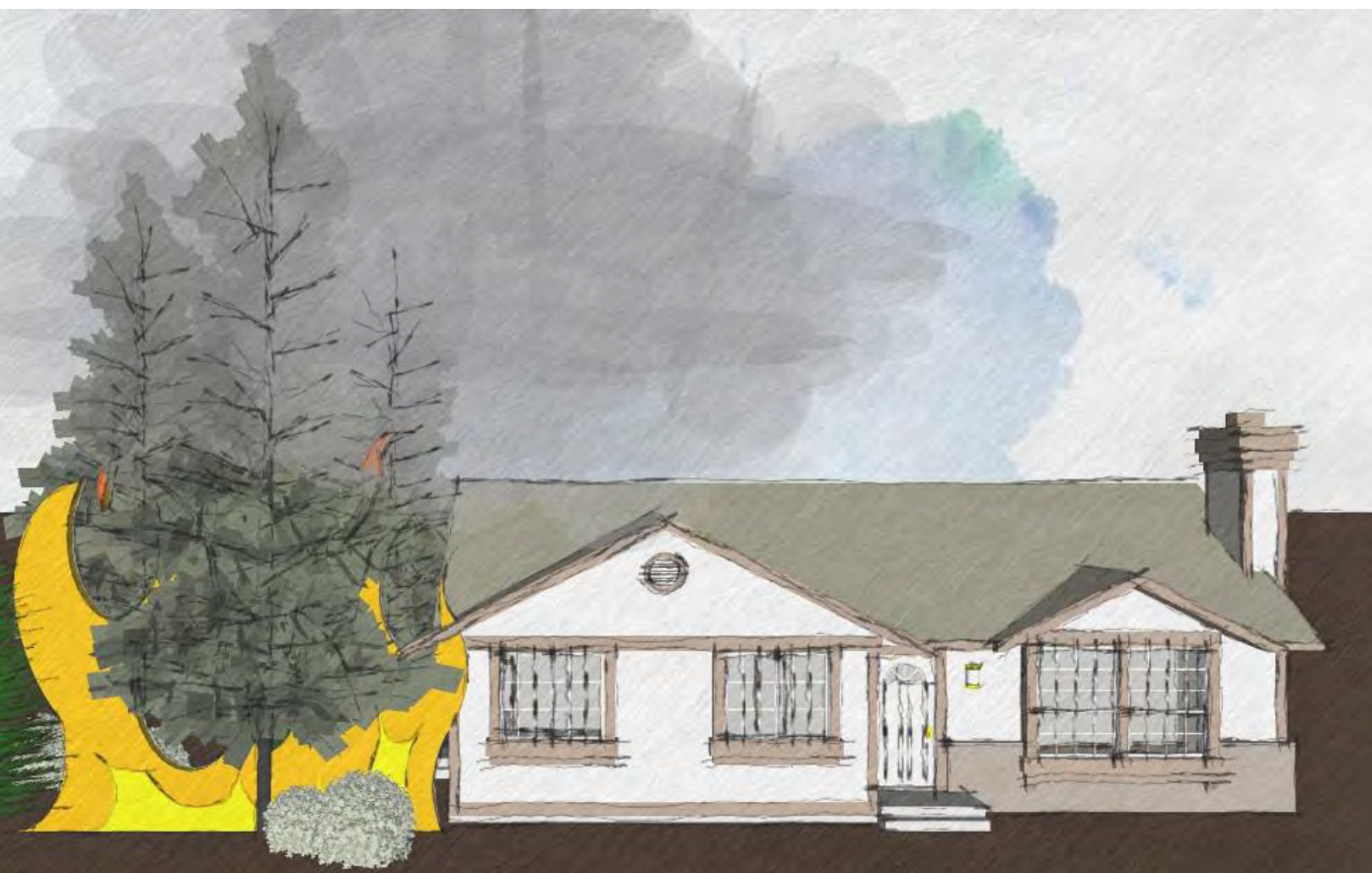
Imatge 22. Transferència per contacte directe de la flama amb el material combustible. La calor es transmet de partícula a partícula, en cadena, per contacte directe. (Font: Medi XXI)
