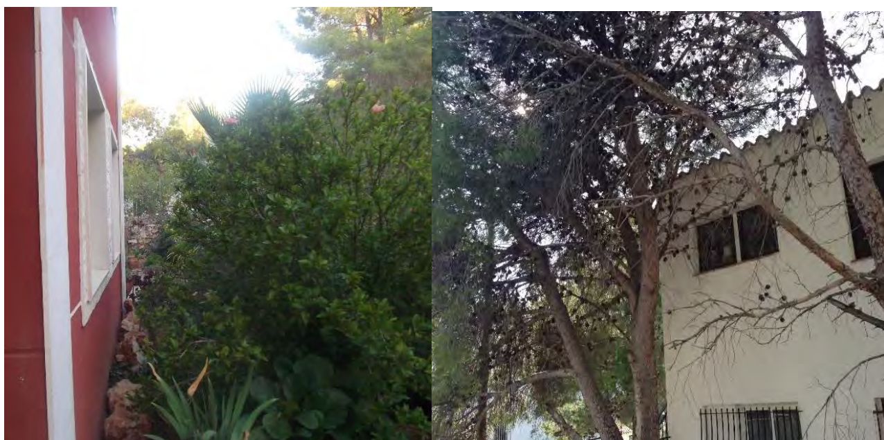
Imatge 84. Incompliments en l'anell més immediat de 0-3 metres. Arbusts en alineació amb les finestres (element vulnerable). Arbratge fins i tot amb vol aeri sobre l'habitatge, molt probablement deixat per l'efecte d'ombregat perenne sobre l'habitatge. (Font de la imatge esquerra: Medi XXI. Font de la imatge dreta: Lluís Regincós. Bombers de la Generalitat de Catalunya.)
