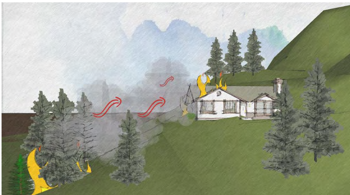
Imatge 23. Transferència a través del moviment de l'aire calent en ascensió durant l'incendi. La massa d'aire calent tendeix a anar cap amunt, i els gasos calents que hi ha, també. Això fa que es preescalfi el material combustible de les zones situades més amunt del front de l'incendi. (Font: Medi XXI)
